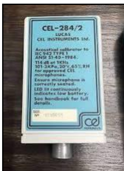
Εικόνα 6-13: Όργανο βαθμονόμησης CEL-284/2 Acoustical Calibrator Class 1L
